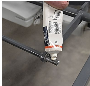
Fett auf die Achse auftragen
