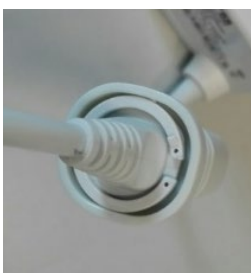
Der Sperring montiert
