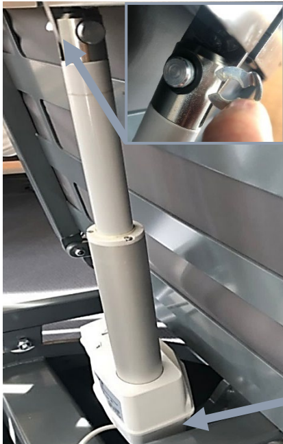
Position von Halteklammer und Bolzen
