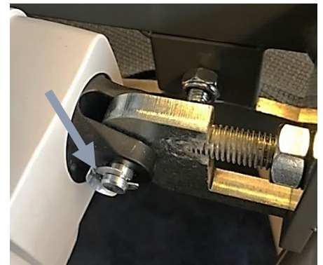
Position der Bolzen auf der anderen Seite des Motors.
