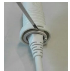
Entfernen der Sperring mit einem Schlitzschraubendreher
