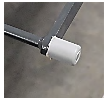
Radläufer wieder an der Achse montieren
