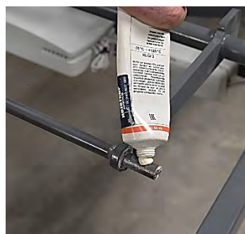
Fett auf die Achse auftragen
