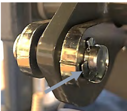
Position der Halteklammer
