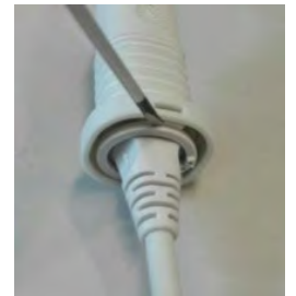
Entfernen der Sperring mit einem Schlitzschraubendreher
