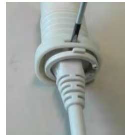
Entfernen der Sperring mit einem Schlitzschraubendreher
