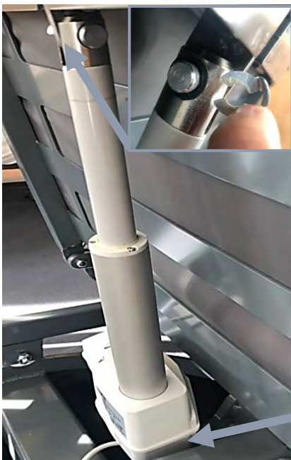
Position von Halteklammer und Bolzen
