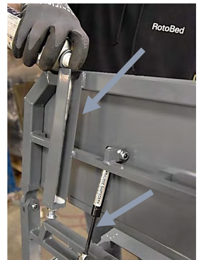
U-Profil und dünne Strebe einsprühen
