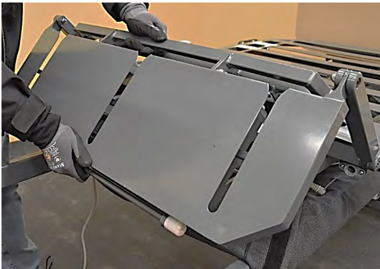
Aus dem U-Profil herausgehobene Radkufen des Beinteils
