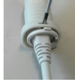
Entfernen der Sperring mit einem Schlitzschraubendreher
