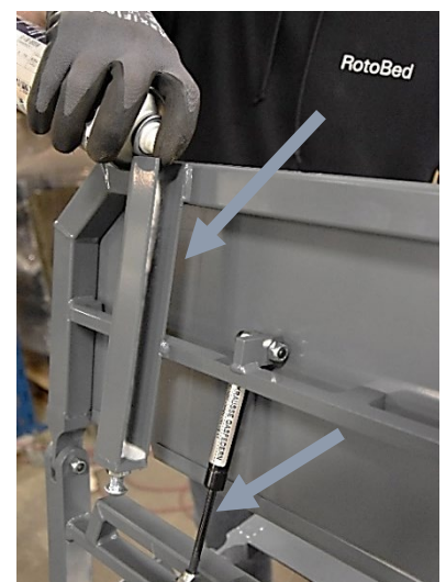
U-Profil und dünne Strebe einsprühen
