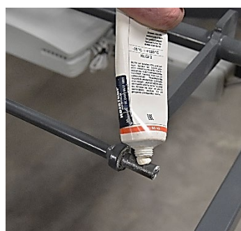
Fett auf die Achse auftragen
