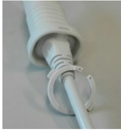
Der Sperring demontiert
